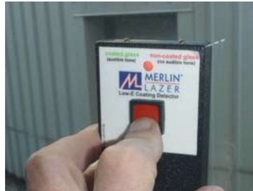
Meranie pozície nízkoemisného povlaku.
