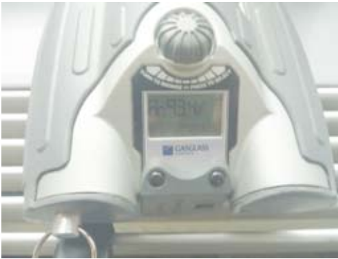
Meranie obsahu argónu prístrojom Gasglass od fy. SPARKLIKE s výsledkom 93,4 % obsahu argónu.
